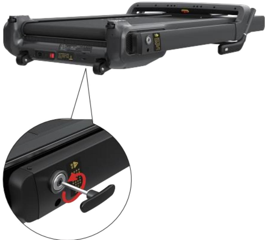
Как показано на рисунке, с помощью ключа (57) ослабьте два винта M8\*105 с левой и правой стороны беговой дорожки (по 5-6 оборотов с каждой стороны), чтобы поднять вертикальную стойку.
