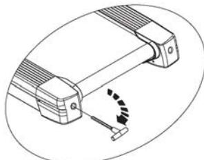
Повторяйте процедуру до тех пор, пока беговое полотно не будет отцентрировано. Запустите полотно на несколько минут для проверки надежности центровки. **ПРИМЕЧАНИЕ: НЕ ПОВОРАЧИВАЙТЕ** регулировочные болты более, чем на один полный оборот в любую сторону. Если после полного поворота беговое полотно по-прежнему не отцентрировано, свяжитесь с представителями компании-продавца.
