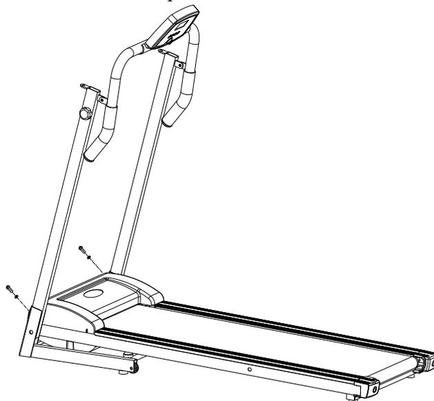
Закрепите их с помощью болта и шайбы с обеих сторон.
